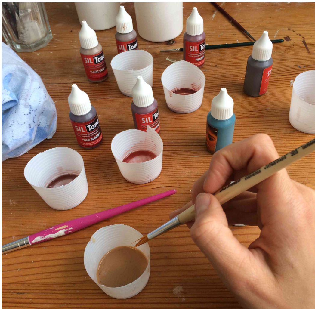
Mischen des 2-Komponenten-Silikons mit Lösungsmitteln und Pigmenten
