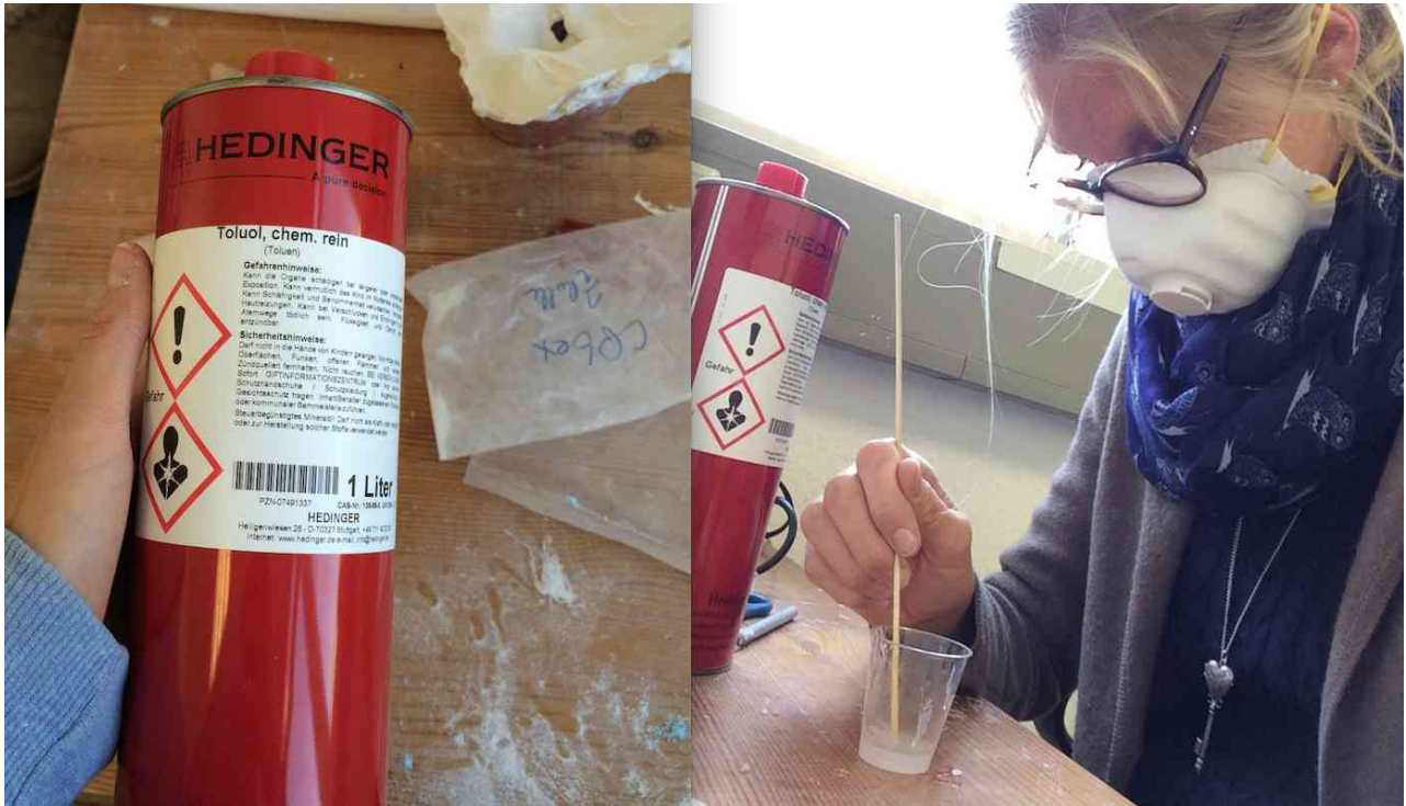
Mischen des 2-Komponenten-Silikons mit Lösungsmitteln und Pigmenten
